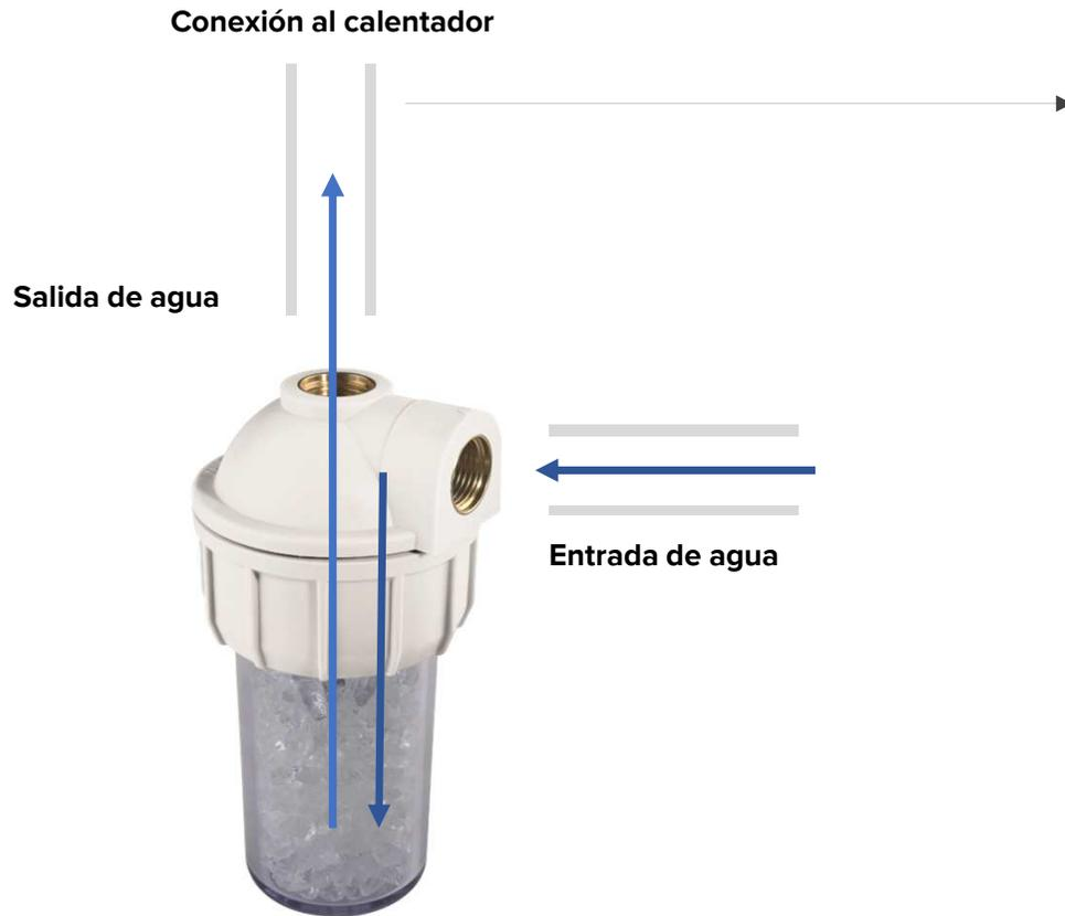
El agua, en contacto con las piedras de polifosfatos, disuelve las partículas, que a su vez se unen a las de carbonato de calcio, reduciendo así su adherencia a otros elementos del termo eléctrico:
